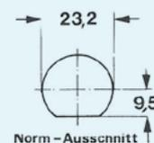
Verschiedene Zylinderoliven sind auch in einer Metallausführung lieferbar. Alle Oliven in dieser Ausführung passen auf den universellen Norm-Ausschnitt. Für individuelle Verschlussmöglichkeiten gibt es diverse Riegel-Varianten. Ein Schraubenstanzwerkzeug erlaubt auch aus bestehenden Metallschränken, Briefkästen, Garderobenschränken usw. (bis 2mm) ein nachträgliches Anbringen des Norm-Ausschnitts.
