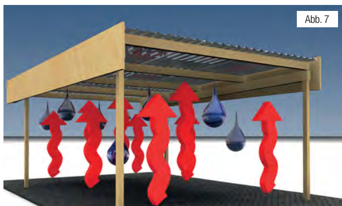
Abb. 7 Feuchtigkeit steigt nach oben und bildet Kondenswasser, das ohne richtige Lüftung von dem Dach abtropfen kann. Deshalb muss für ausreichend Luftstrom gesorgt werden.
